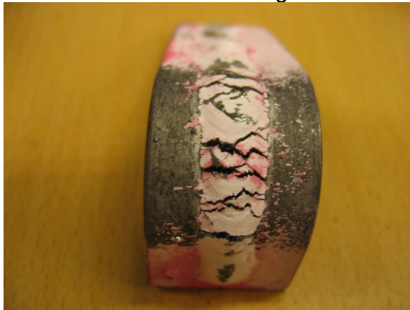
Voorbeeld van een door Cu gescheurde las
