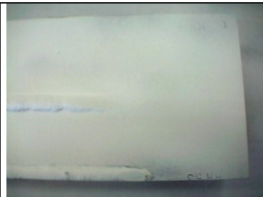
Magnetisch onderzoek 1a Geslepen las bedekt met contrastverf,
