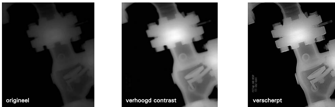
figuur 9.37 Beeldverbetering door contrastverhoging en verscherping
