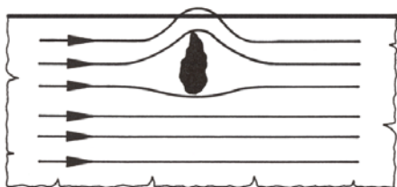
figuur 4.3 Veldverloop in een werkstuk met een inwendige fout
