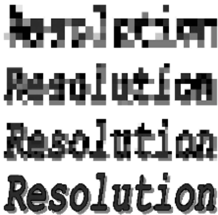
figuur 9.31 Effect van het aantal pixels op de "leesbaarheid"
