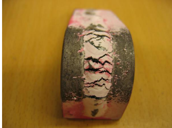
Voorbeeld van een door Cu gescheurde las
