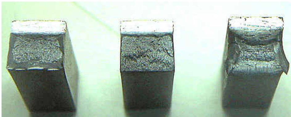
Figuur 31 Breukvlak van enkele kerfslagstaafjes
