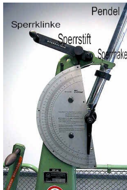
Figuur 27 Kerfslaghamer en positie van het proefstaafje. detail van de wijzerplaat met schaalverdeling en meeneemwijzer
