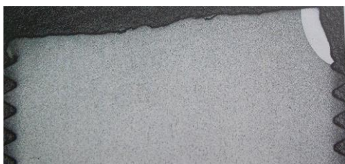
Bout, doorsnede, zichtbaar is een deel van een hechtglas (licht geëtst)
