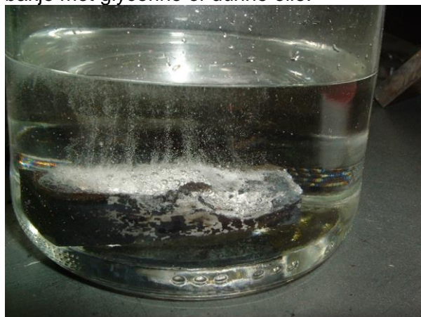
Waterstof diffundeert uit lasmetaal (staal) Diffusie vanaf 0 tot 3 dagen (ca 90-95%) Na 48-72 uur is NDO toegestaan
