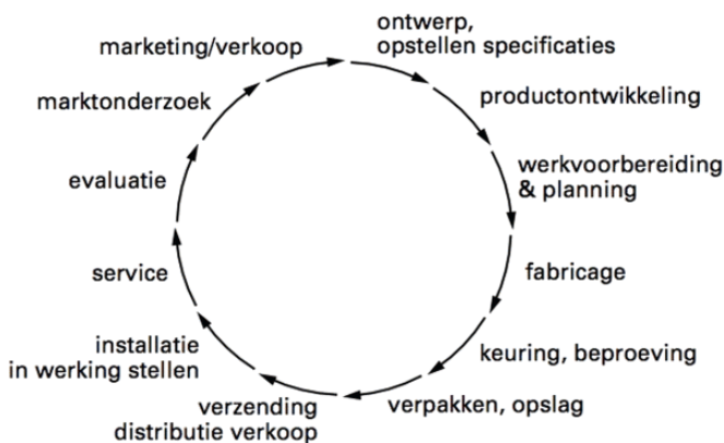
figuur 1.1 Schakels in de voortbrengingsketen (kwaliteitskringloop)
