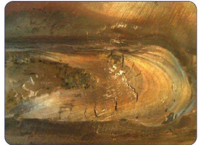
warmscheuren varestraint proefstuk 4% rek
